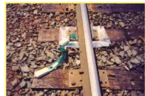
Järnvägsbolag använder Tekscans system för analys av yttrycket mellan räls och slipers.
